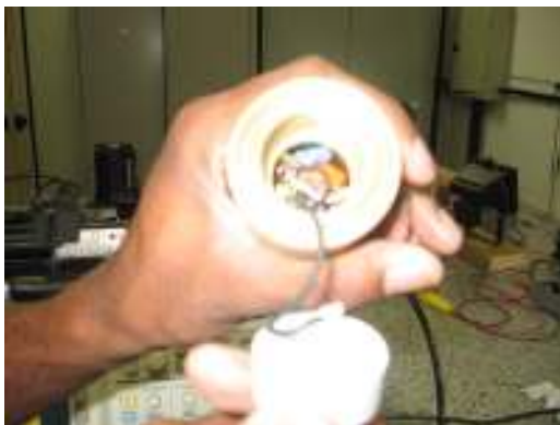
Fig.1: Célula fotoacústica com o circuito pré-amplificador interno construído.
